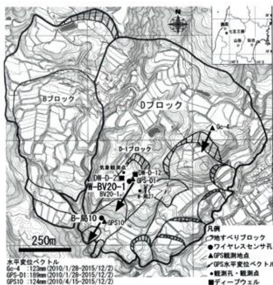
図-1 調査位置図およびDブロック水平変位ベクトル Fig.1 Index map of the Shimekake landslide and horizontal displacement vectors in the D block
